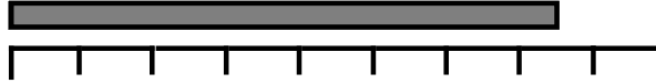
Figura 1.1: Incertezza nella misurazione di una lunghezza, dovuta alla risoluzione finita dello strumento di misura.
