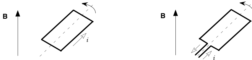
Figura 5.15: Una spira rettangolare posta in rotazione in un campo uniforme \vec{B} è sede di una corrente di verso alternato (a sinistra). Se la spira è aperta e connessa ad un circuito esterno, il dispositivo può essere utilizzato come generatore di corrente alternata.
