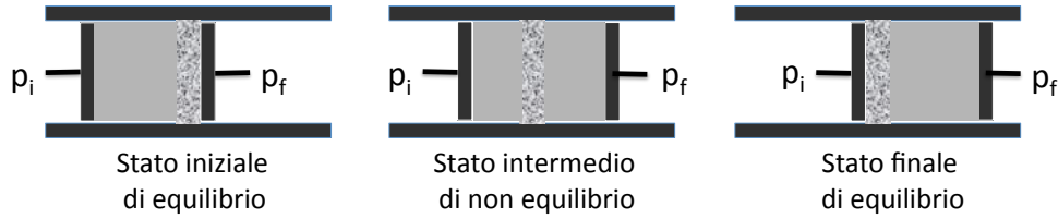
Figura 10.3: Rappresentazione schematica dell'effetto Joule-Thomson. A sinistra lo stato di equilibrio iniziale, con tutto il gas a sinistra del setto poroso. A destra lo stato di equilibrio finale, con tutto il gas a destra del setto poroso. Gli stati intermedi non sono stati di equilibrio; la trasformazione non è reversibile.
